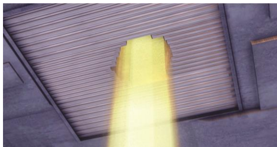
図2: より細かな照射野を形成可能なマルチリーフコリメータ
