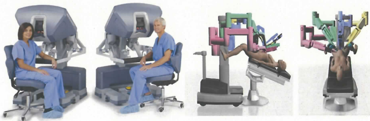
(図2): マスタースレーブ方式におけるコンソールとロボットアーム
